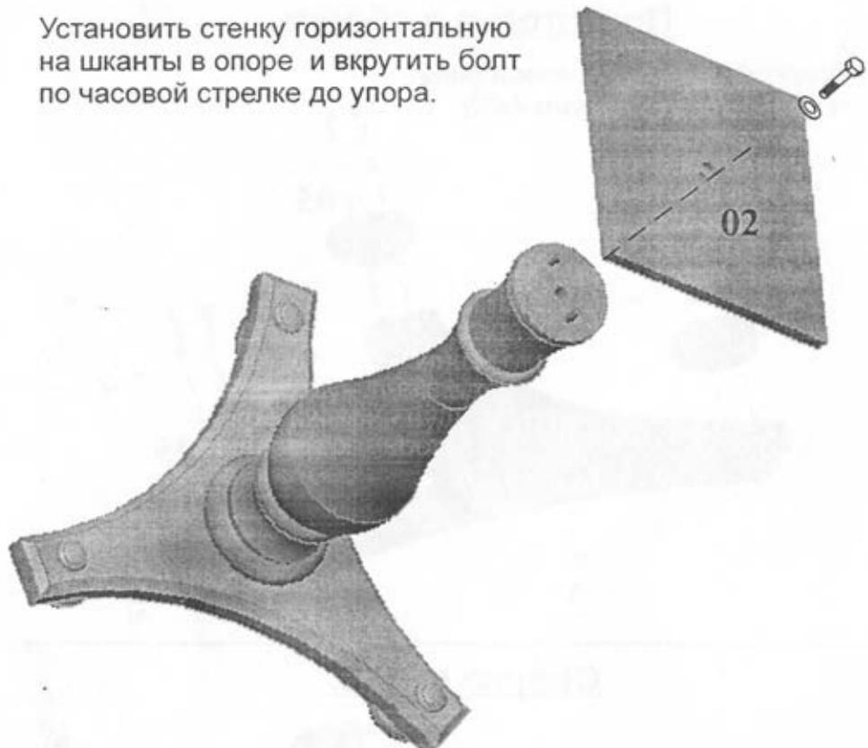
Установить на крышку опору со стенкой горизонтальной и крестовиной. Крепить опору к крышке через сквозные отверстия в стенке горизонтальной винтами M6x25
